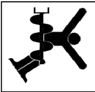
**Держите дальше свободные части одежды, обувь, части тела, посторонние объекты и т.д. , как можно дальше от вращающегося сверла ! Всегда используйте только шпильку # 1300 для крепления сверла к валу мотобура! Столкновение со скрытыми в земле предметами, может вызвать неожиданный удар, физические повреждения и смерть оператора !**
