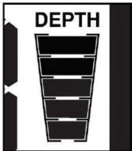
Для более крупных объектов и объектов неправильной формы надежность определения глубины ниже. При проходе над объектом индикатор глубины загорается и не изменяется до обнаружения следующего объекта.
