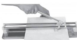
3. При помощи рукоятки (3) опустите режущий ролик на плитку, слегка надавите на рукоятку и проведите каретку вдоль линии реза по направляющим (4) от себя. Следует производить только один проход режущего ролика.
