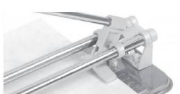
4. Поднимите рукоятку верх и снова опустите так, чтобы лапка коснулась линии реза. Надавите на рукоятку до тех пор, пока плитка не сломается по линии реза.
