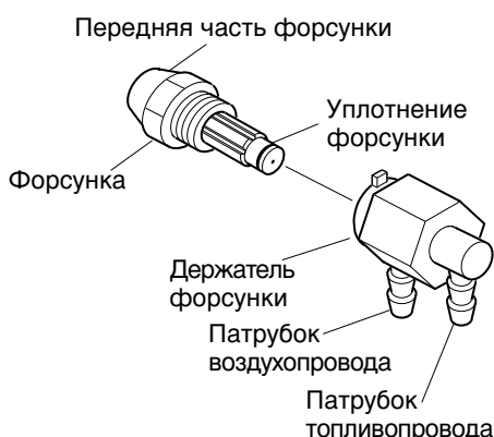
Рис. 22. Форсунка и держатель форсунки, нагреватель мощностью 10 кВт
