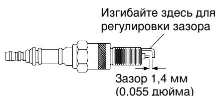
Рис. 12. Регулировка зазора свечи зажигания, нагреватель мощностью 10 кВт
