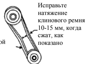
Рисунок 2. Натяжение клинового ремня
