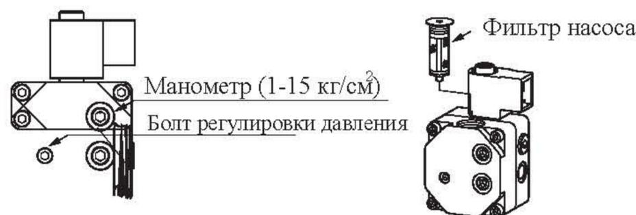
Рис. 7. Топливный насос (TKI-240K)
